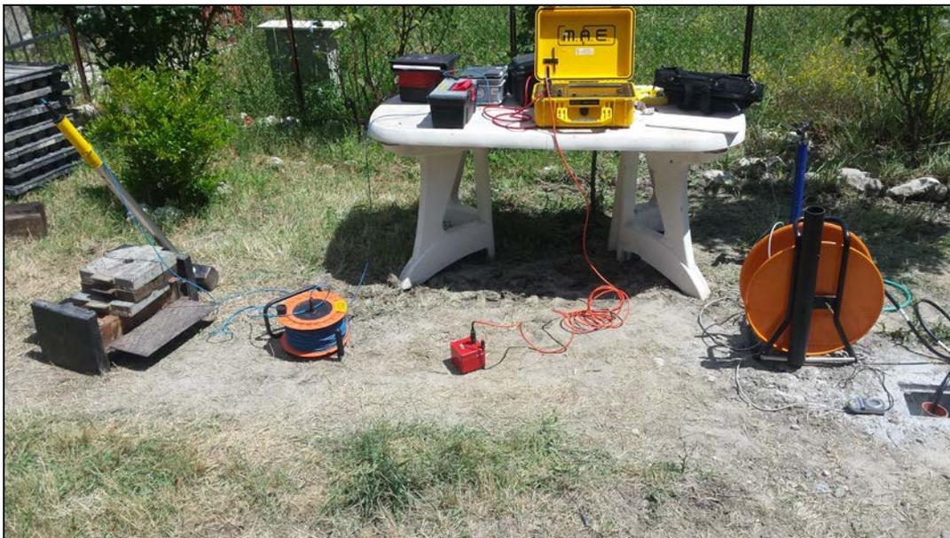
**Figura 21** Sismografo Mae A6000S, sensore 3D 4,5 Hz Geospace
