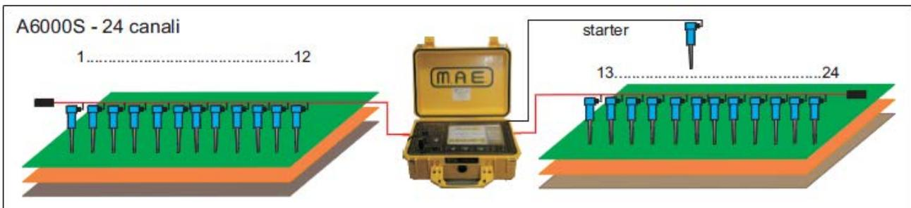
Figura 1 Configurazione array
